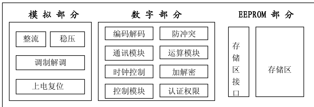
图1 TKS50 芯片内部原理框图
